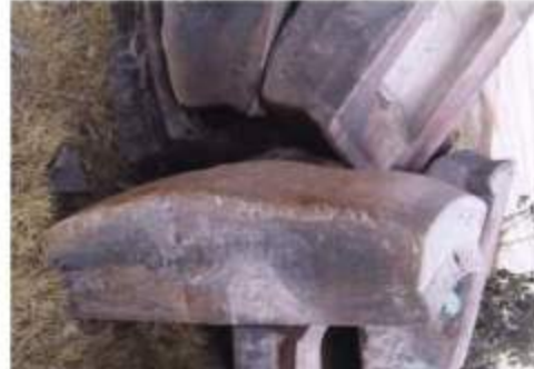
再生堆焊辊皮磨损一年后
