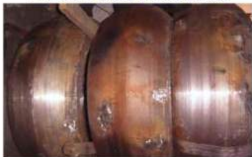
MPF2116 铸造新品预留堆焊层
