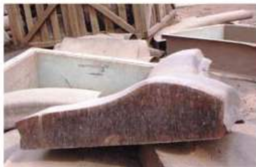
高铬新品辊皮磨损一年后
