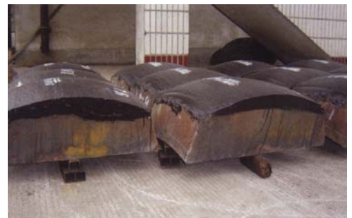
辊皮堆焊修复后
