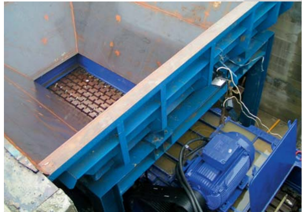
Walzenbrecher Typ WB 0714: 500 t/h ROM Kohle auf 0-50 mm Roll crusher type WB 0714: 500 t/h ROM coal into 0-50 mm
