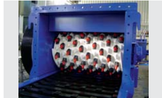
Walzenbrecher Typ WB 0714: 500 t/h ROM Kohle auf 0-50 mm Roll crusher type WB 0714: 500 t/h ROM coal into 0-50 mm
