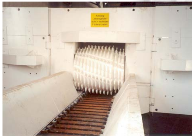
Einstufiges Brechen von Kreide von ROM-Größe auf 0-50 mm One-step crushing of chalk from ROM-size down to 0 - 50 mm
