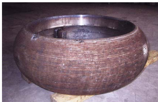
MPS200K 堆焊完成复合磨辊
