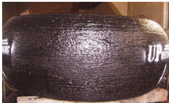
MPF1814 堆焊完成复合磨辊
