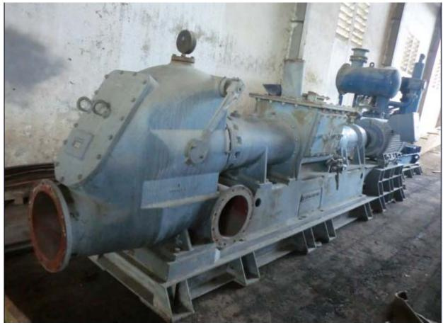
Pic No 01 : Screw Ibau Pump IB- D350
