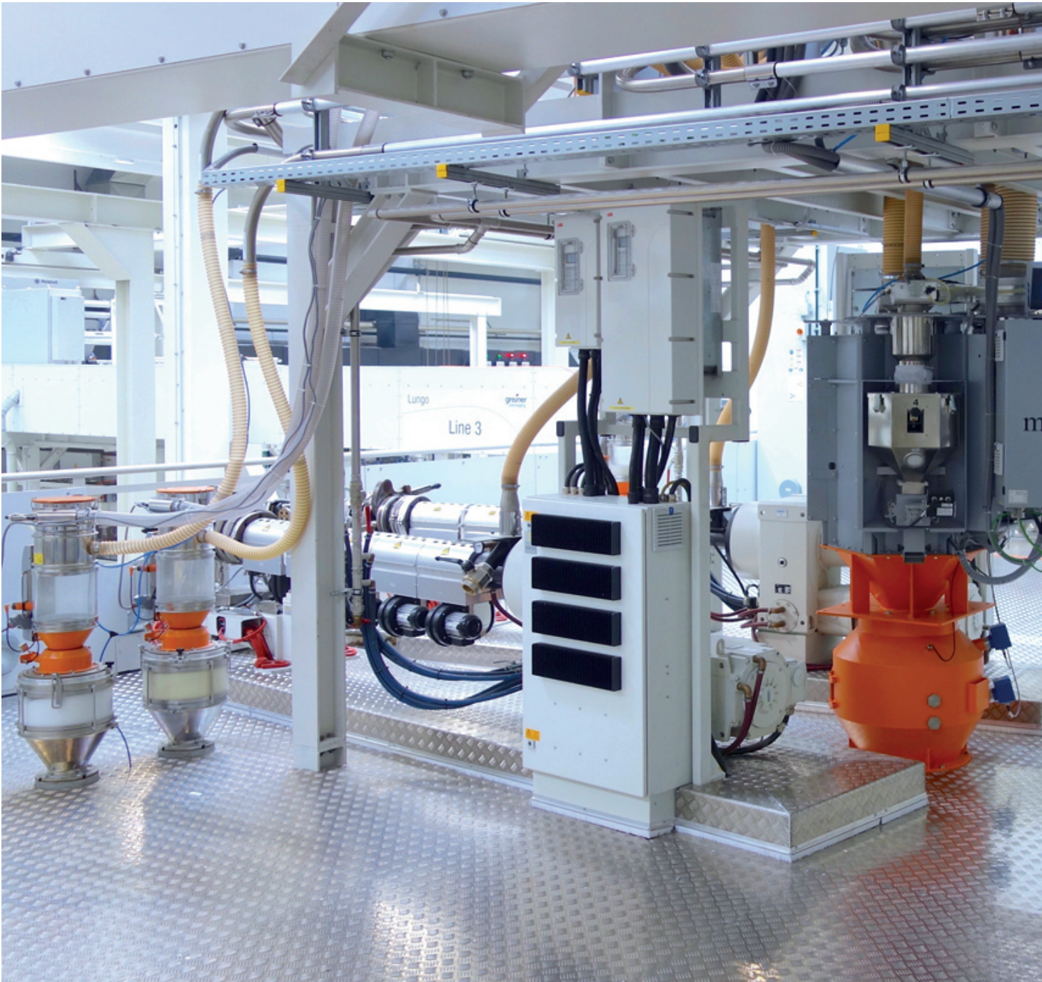
Abb.5: Zentrale Mischstation zur Versorgung des „Mahlgut-Extruders“. In ihr treffen vier Materialkomponenten (Mahlgut aus dem Silo oder aus dem Big-Bag, Stabilisator für den Haftvermittler und PP-Neumaterial) zusammen, die aus den gravimetrischen Dosiergeräten in der dritten Ebene zudosiert werden.
