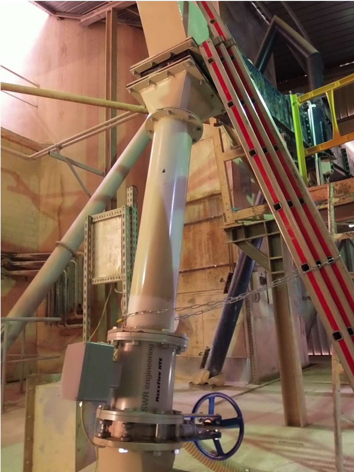
Mühlenrücklaufmessung mittels MaxxFlow in der Zementindustrie. (Bild: SWR engineering)
