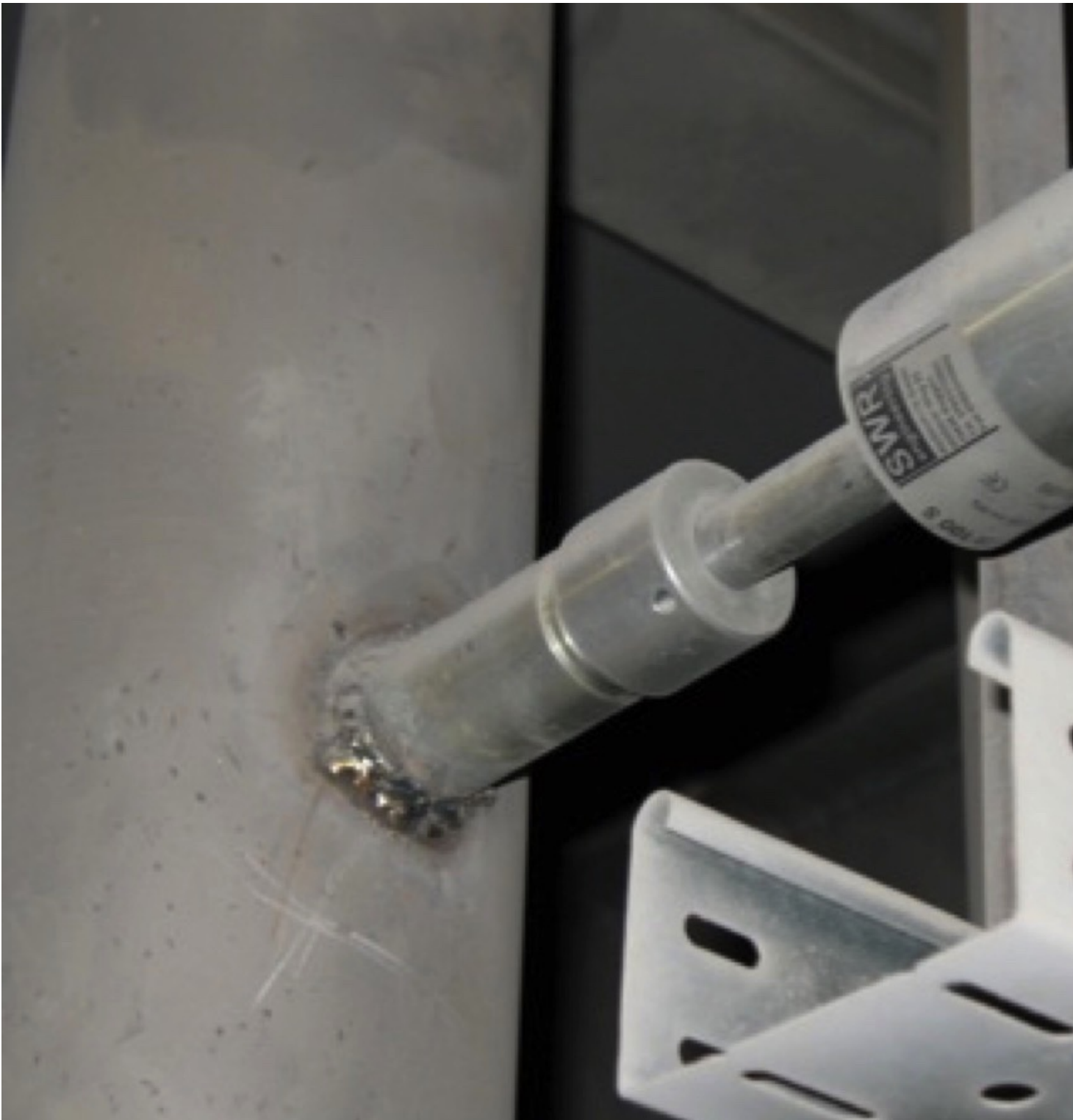
SolidFlow Mikrowellensensor zur Erfassung der Beimengung von Eisen(II)-Sulfat bei der Zementherstellung. (Bild SWR
