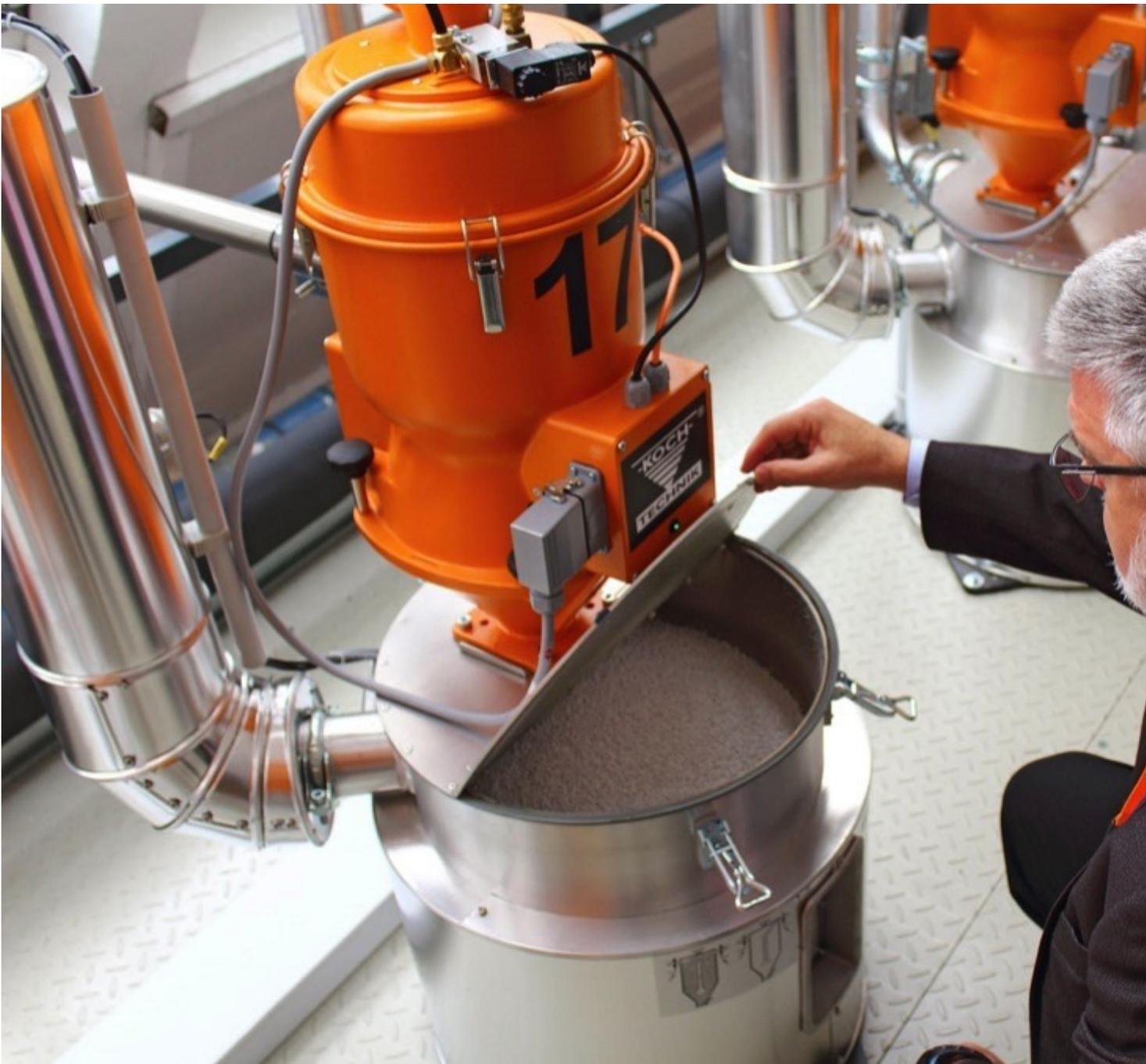
Granulattrocknung: Jeder Trocknungsbehälter lässt sich aufklappen. Die großen Trocknungsbehälter haben zusätzlich eine Reinigungstür, anstelle des Sichtfensters an der Frontseite.
