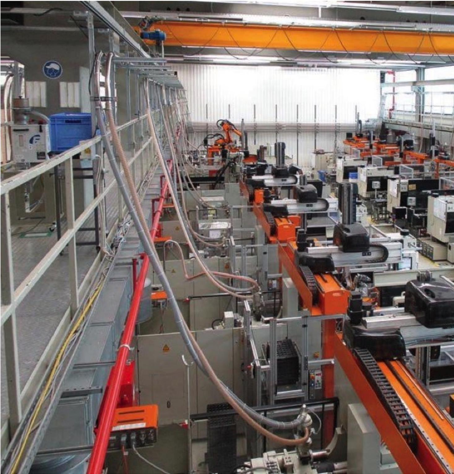
Bei P&G Braun kommen alle Kunststoffteile für die BRAUN-Produkte aus der eigenen Spritz- gießerei. An 350 Tagen im Jahr wird hier in vier Schichten an 31 Spritzgießautomaten mit Schließkräften zwischen 50t bis 300t gearbeitet.
