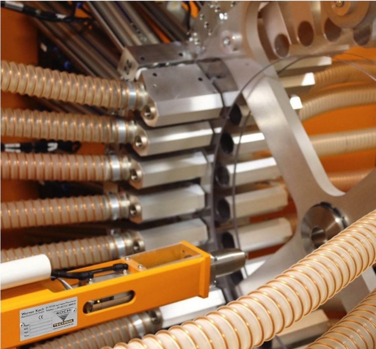
Materialleitsystem Navigator: Wird Material gefördert, fahren die pneumatischen Schieber die gewünschte Material- und die Maschinenleitung in der Mitte zusammen. Die Leitungen werden für die Dauer des Materialtransports direkt miteinander verbunden.
