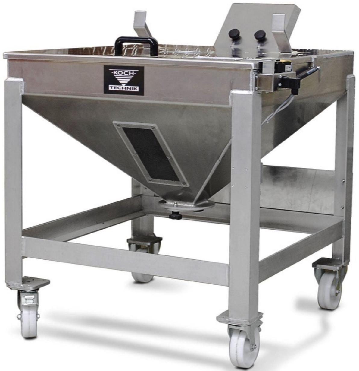
Materialbereitstellung: Die Materialcontainer, auch Sackaufgabebehälter genannt, öffnen sich erst, wenn das einzufüllende Material zuvor über Barcode-Scanns verifiziert wurde.
