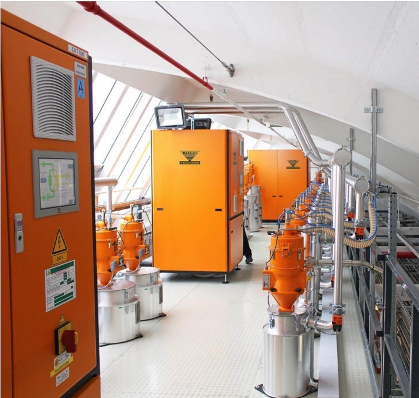
Granulattrocknung: Die Trocknungsanlage auf der Bühne wurde im Aufbau zentimetergenau an die Geometrie des Sheddachs angepasst. Die Verrohrung daneben weist dem Material über vier Navigatoren den richtigen Weg zur Verarbeitung.
