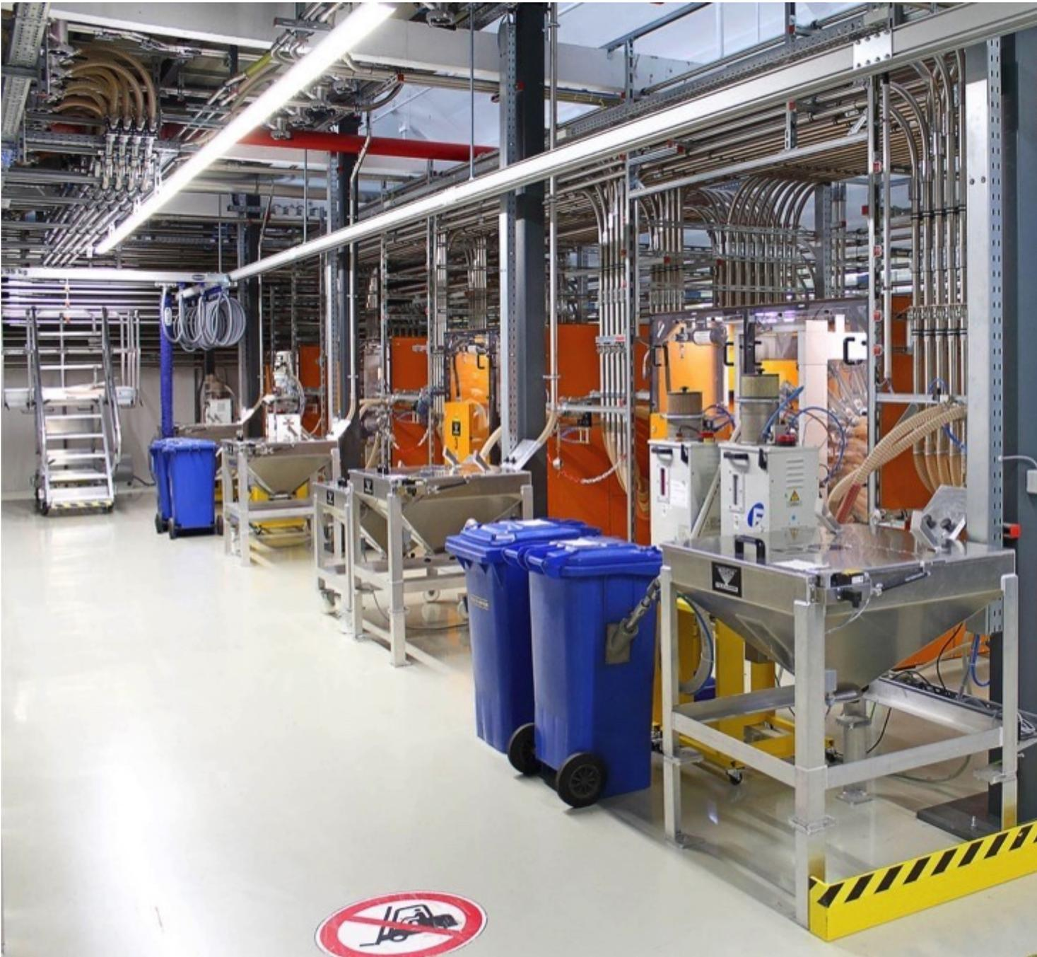
Materialverteilung: „Kunstfertig verlegte“ materialführende Leitungen prägen das Bild um die vier Navigatoren, die zusammen Material speichern unterhalb einer Bühne, auf der die Granulattrockner stehen, installiert wurden.
