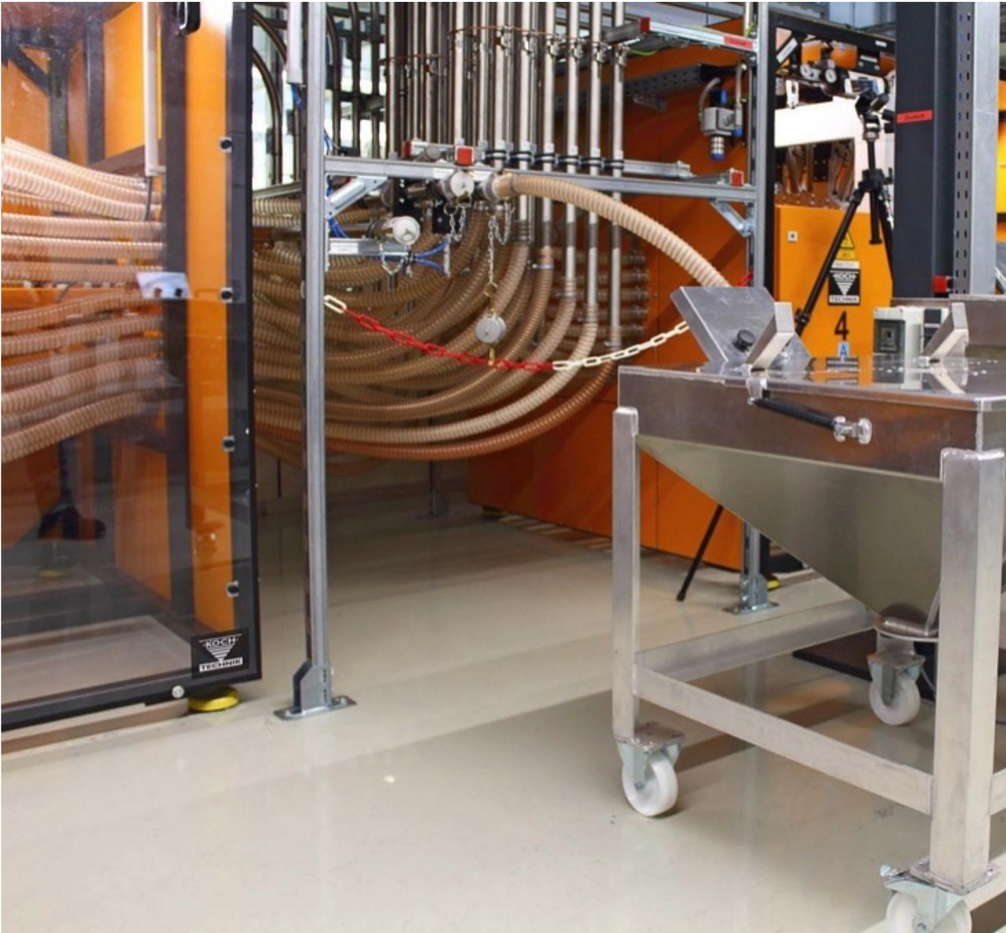
An jedem Navigator sind noch zwei Eingänge für Kaltmaterial vorgesehen. So können unkompliziert Testläufe für Versuchsreihen gefahren werden.
