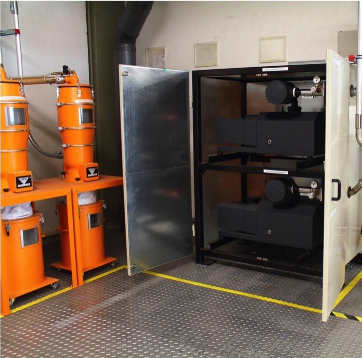
Die Vakuumpumpen für ein gleichbleibendes Permanentvakuum arbeiten frequenzgeregelt, was den Energieverbrauch senkt und die materialführenden Leitungen vor Verschleiß schützt. Sa3 Sicherheitsfilter reinigen vor dem Einsaugen die Luft von allen Fremdpartikeln die größer als  $2\ \mu\text{m}$ , also  $0,002\ \text{mm}$ , sind.
