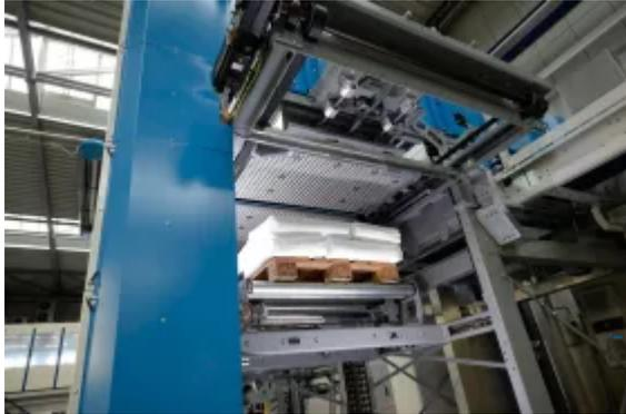
Der Hubwerksbereich des BEUMER paletpac in Aktion. Die Maschinen erreichen bei Zement zum Beispiel einen Durchsatz von bis zu 6.000 Säcken pro Stunde.
