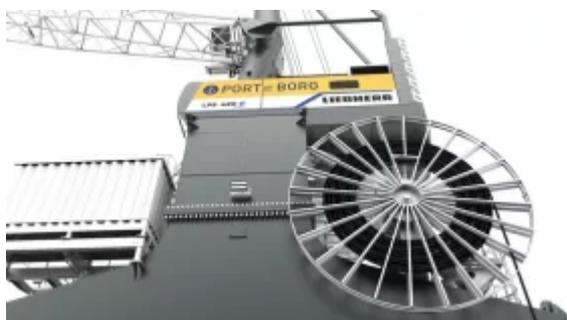
Der vollelektrische LPS 420 E unterstützt eine umweltfreundlichere Infrastruktur im Hafen, da er ohne Hydrauliköl oder Dieselmotor arbeitet. (Bilder: ©Liebherr-MCCtec Rostock GmbH)
