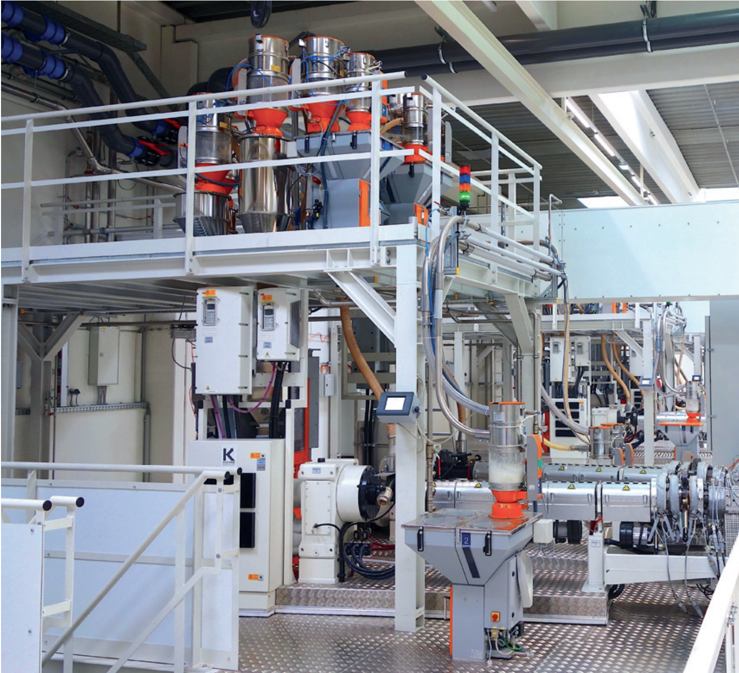
Abb.4: Die 7-Schicht-Folienanlage ist in drei Funktionsebenen übereinander aufgebaut. Auf der untersten Ebene (hier nicht sichtbar) befinden sich drei Extruder (siehe Abb.3), auf Ebene zwei befinden sich die zwei Extruder für die Deckschichten, auf der obersten Ebene die Dosiergeräte zur Versorgung der darunter befindlichen Extruder.
