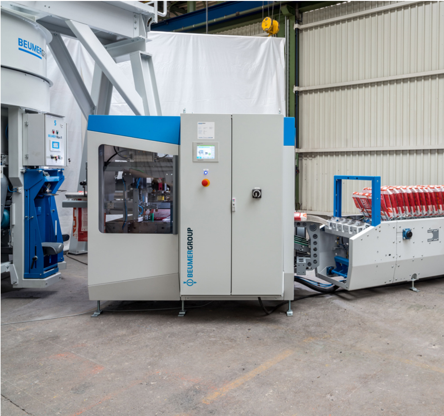
Abb. 2: Das Greifsystem und die Aufschusseinheit stecken die Säcke sicher auf den Füllstutzen
