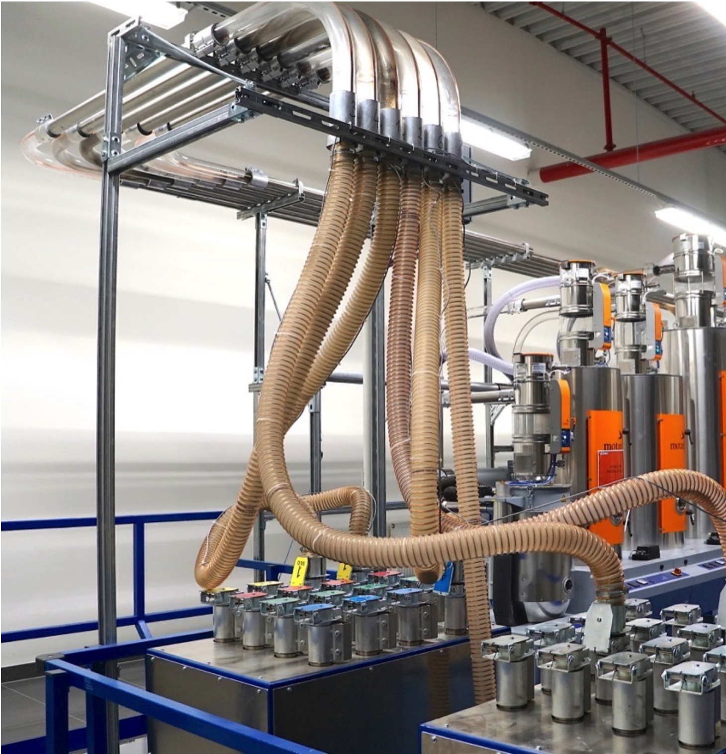
Abb. 6: Manuell zu bedienender Kupplungsbahnhof zur flexiblen Versorgung der Verarbeitungsmaschinen mit getrocknetem Kunststoffgranulat. (Foto: Reinhard Bauer)
