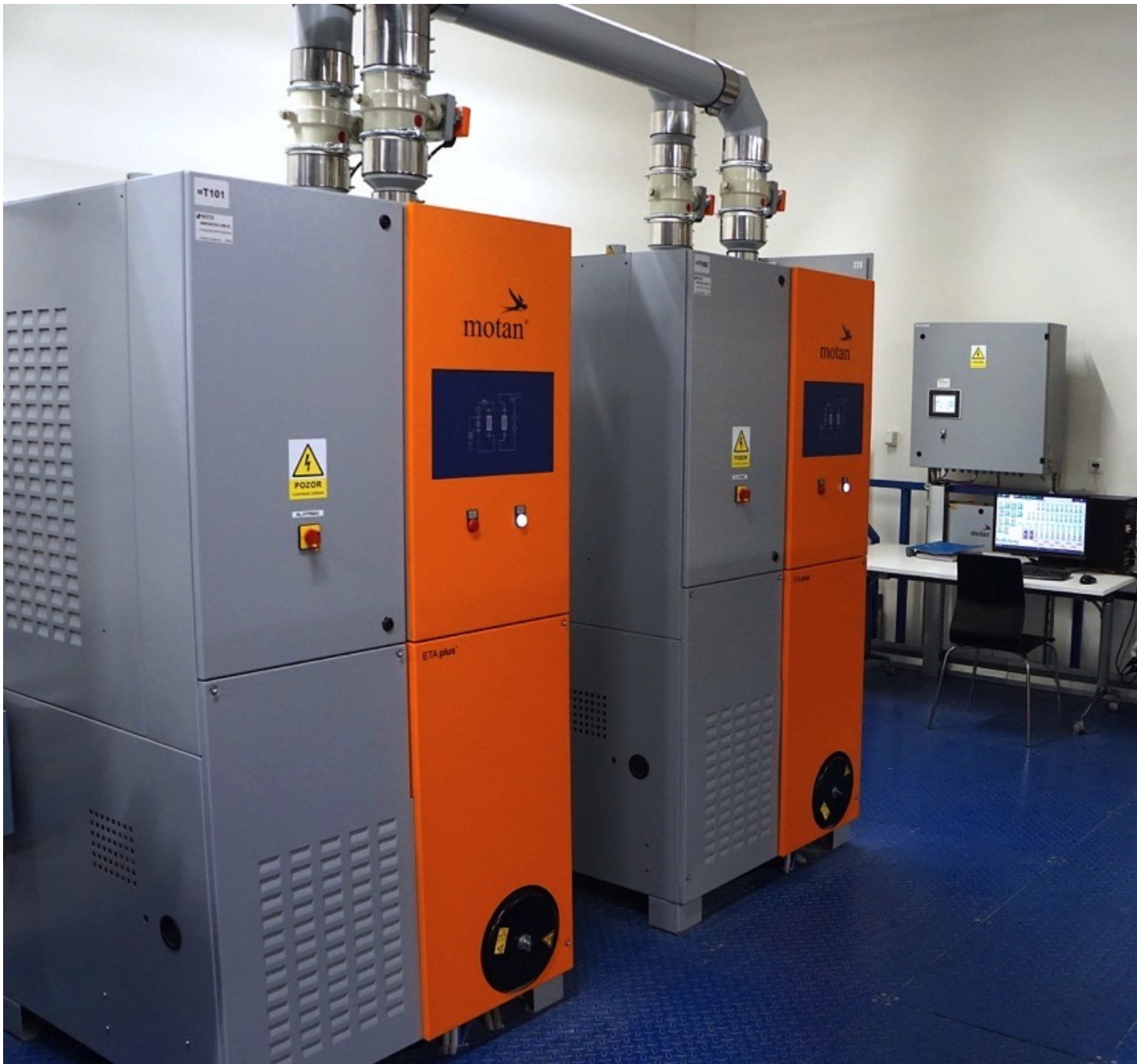
Abb. 5: Die LUXOR A Baureihe mit der energieeffizienten ETA-process® und ETA plus® Trocknungstechnologie umfasst zehn Modelle mit einer Trockenluftleistung von 80 bis 2400 cubic meter per hour. Sie sind ausgestattet mit stationären, isolierten Molekularsiebpatronen mit separaten Trocknungs- und Regenerierprozessen, die einen konstant niedrigen Taupunkt für den Prozess generieren. (Foto: Reinhard Bauer)
