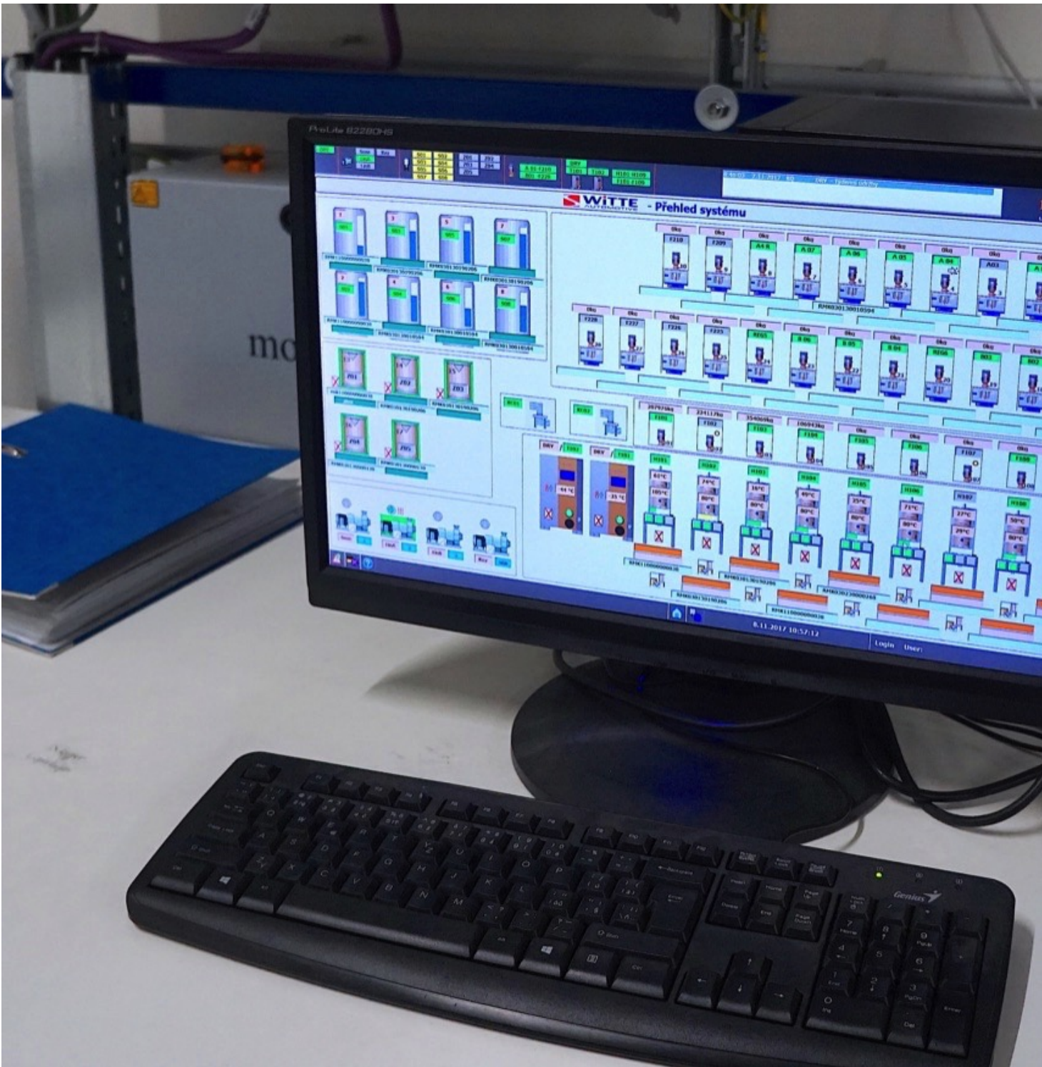
Abb. 9: Die Funktionen und Einstelldaten der Zentralanlage werden über motan LINKnet visualisiert und fernbedient. (Foto: Reinhard Bauer)
