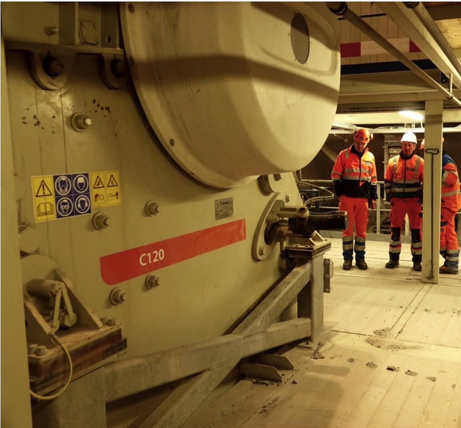
Der bereits 2012 eingebaute stationäre Metso Backenbrecher C120 trägt bereits zur Erhöhung der Produktivität bei Zingel bei. (Bild: Drossard)
