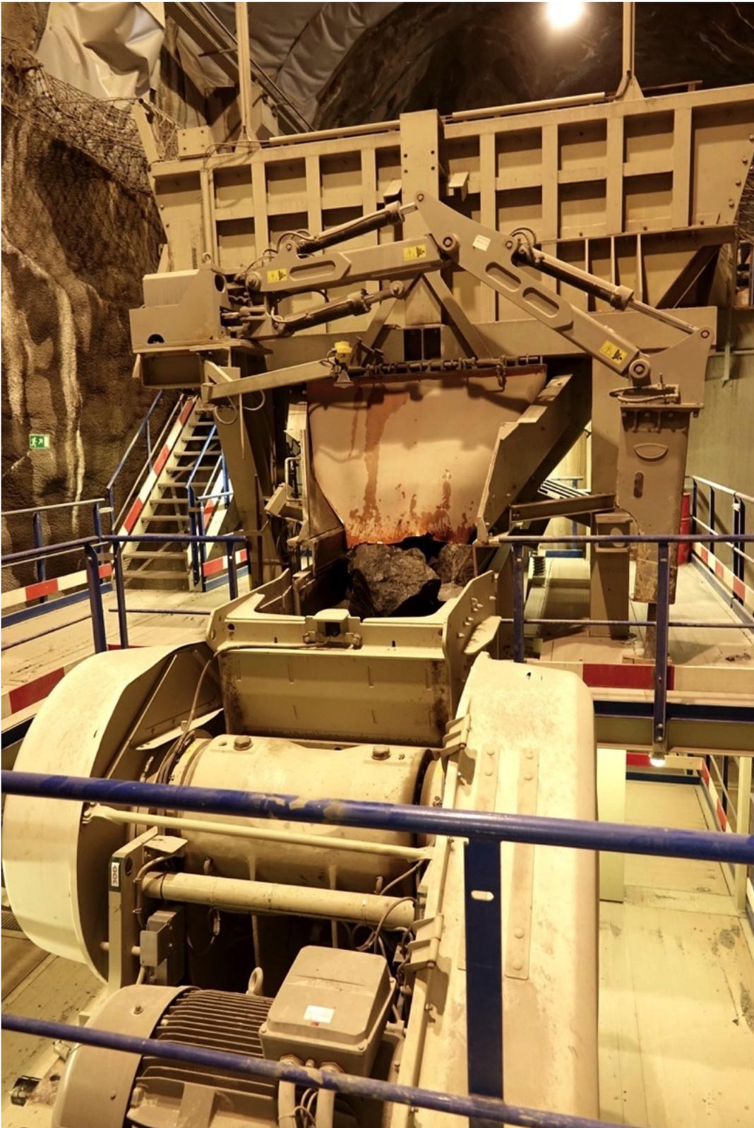
Die eingebaute Vorbrecher-Anlage beeindruckt durch ihren weitestgehend vibrationsfreien Brechbetrieb, der sich als äußerst schonend für den Stahlbau erweist. (Bild: Drossard)
