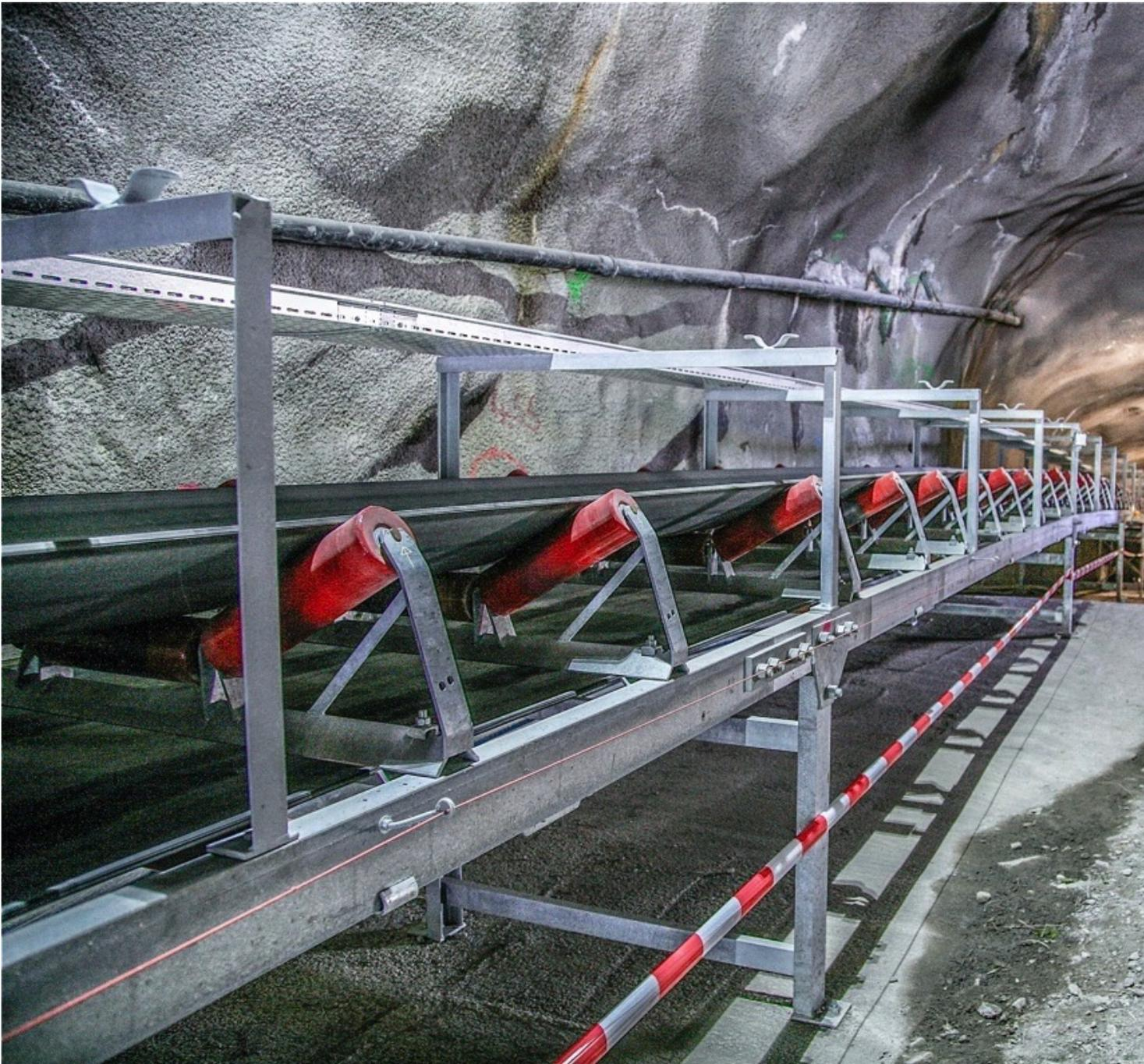
Die 400 m lange Bandanlage verbindet den Vorbrecher in der Kaverne mit dem Werk. (Bild: Drossard)
