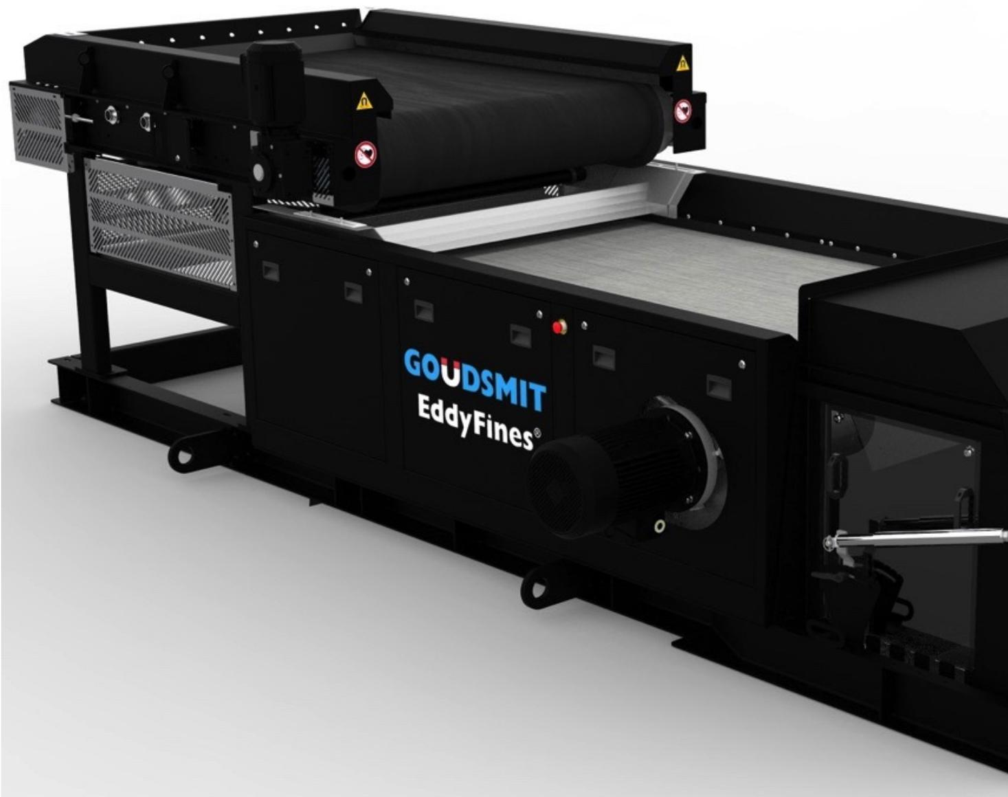
Speziell für die IFAT bringt Goudsmits Magnetics eine schwarze Ausführung des EddyFines 38HI Eddy-Current-Abscheiders heraus. Dieser entfernt NE-Fraktionen ab 0,5 mm aus unter anderem Verbrennungsschlackenströmen.
