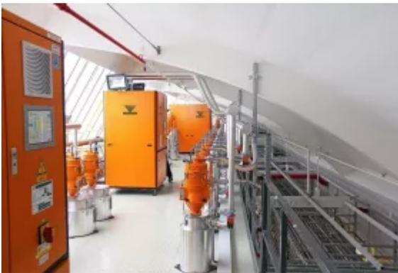
Granulattrocknung: Die Trocknungsanlage auf der Bühne wurde im Aufbau zentimetergenau an die Geometrie des Sheddachs angepasst. Die Verrohrung daneben weist dem Material über vier Navigatoren den richtigen Weg zur Verarbeitung.
