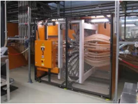
Materialverteilung: Über die Navigatoren kann jede Bedarfsstelle in der Spritzerei mit jedem vorbereiteten Material versorgt werden.
