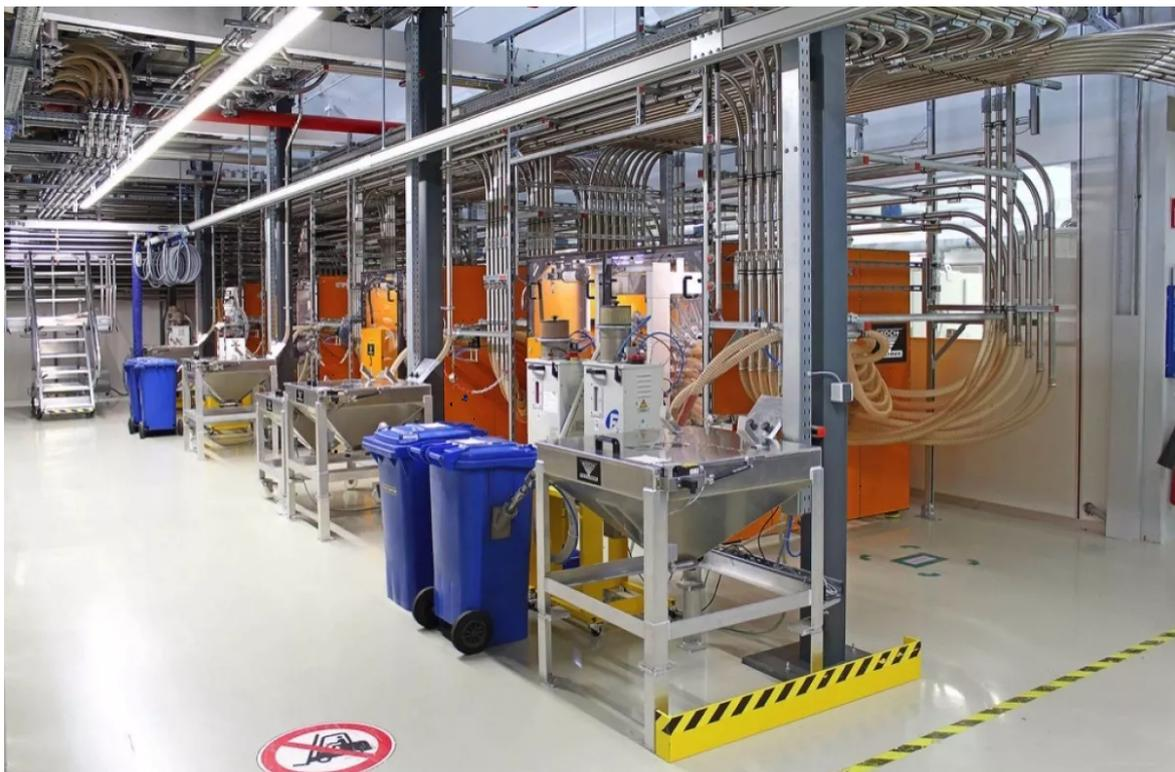
Materialverteilung: „Kunstfertig verlegte“ materialführende Leitungen prägen das Bild um die vier Navigatoren, die zusammen Materialspeichern unterhalb einer Bühne, auf der die Granulattrockner stehen, installiert wurden.
