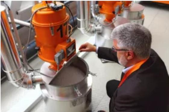
Granulattrocknung: Jeder Trocknungsbehälter lässt sich aufklappen. Die großen Trocknungsbehälter haben zusätzlich eine Reinigungstür, anstelle des Sichtfensters an der Frontseite.
