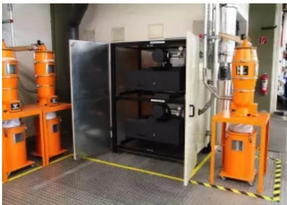
Die Vakuumpumpen für ein gleichbleibendes Permanentvakuum arbeiten frequenzgeregelt, was den Energieverbrauch senkt und die materialführenden Leitungen vor Verschleiß schützt. Sa3 Sicherheitsfilter reinigen vor dem Einsaugen die Luft von allen Fremdpartikeln die größer als 2 µm, also 0,002 mm, sind.
