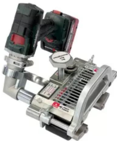
Dank seines elektrischen Antriebs entfernt der Bandhobel die obere Banddecke viel schneller und effizienter als herkömmliche Geräte. (Bild:
